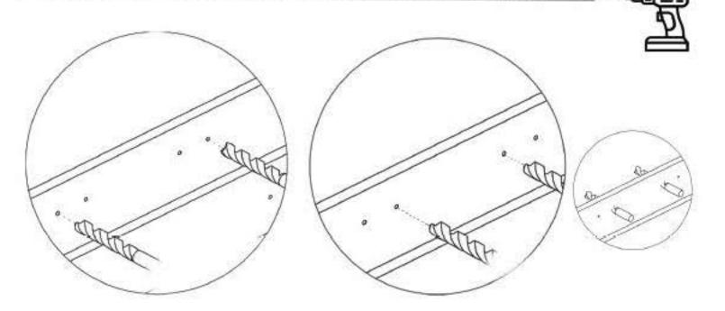
Se prinde cu surubelnita manerul pe placa (4) cu suruburi aferente fiecarui maner. cate 2 buc/ maner.
