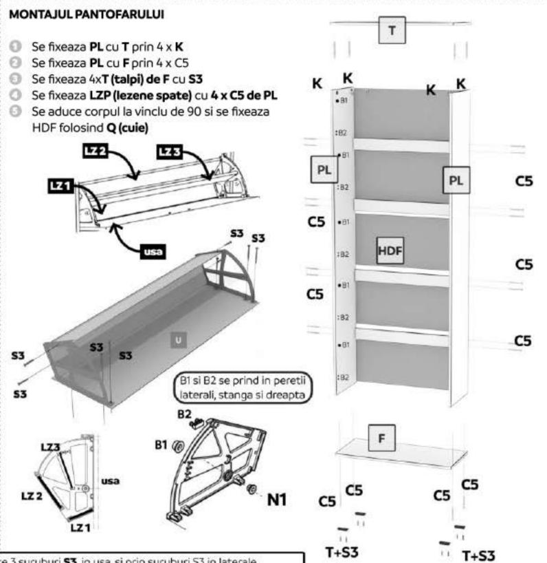
Se monteaza sistemul de pantofar XP cu cate 3 suruburi \$3 in usa, si prin suruburi \$3 in laterale. Inainte de a fixa sistemul in peretii laterali se for fixa lezenele LZ 1 si LZ 2 in cate un surub S3 in fiecare parte (stanga+dreapta). Lezena LZ 3 este mobila si poate fi ajustata in functie de preferinte.
