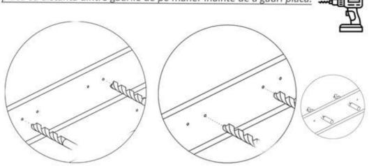
Se prinde cu surubelnita manerul pe placa (4) cu suruburi aferente fiecarui maner. cate 2 buc/ maner.
