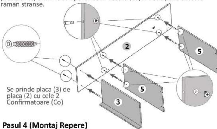
Se prinde placa (1) de placile (5) cu demontabili (De) x 4 buc in gaurile prestabilite, urmand ca apoi sa se infileteze (Ca) x 4 buc pana acestea
