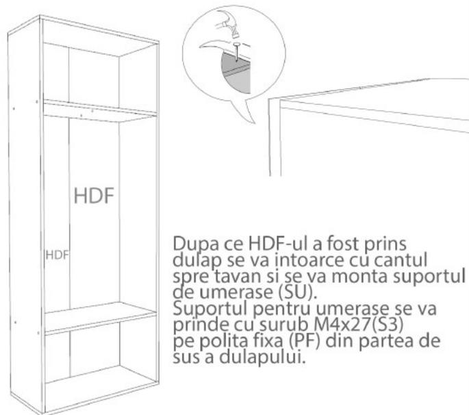
Dupa ce HDF-ul a fost prins dulap se va intoarce cu cantul spre tavan si se va monta suportul de umerase (SU).
